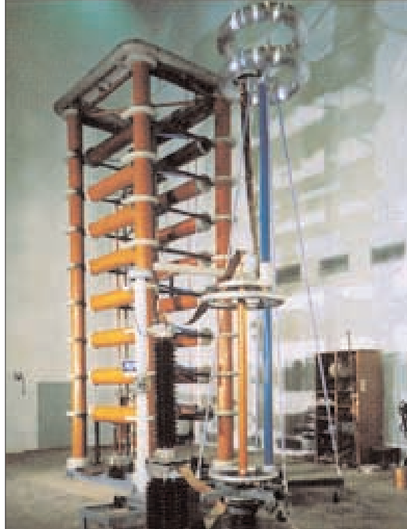
Restspannungs-Prüfung/ Residual voltage test
