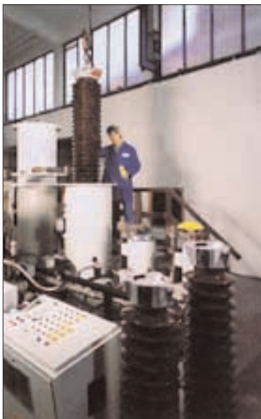
Integrierte Heliumsuche/ Integrated Helium leakage test
